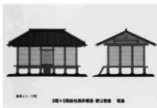
図14 3×5間柱柱高床構造
