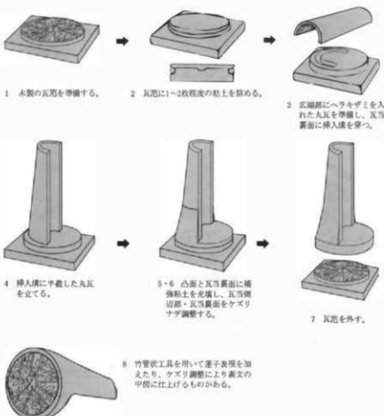
Fig18 花葉文軒丸瓦の製作工程
