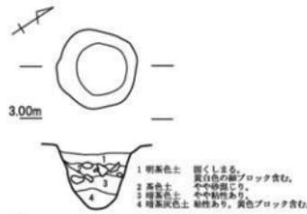
第16図 S5平面図・断面図 (1/40)
