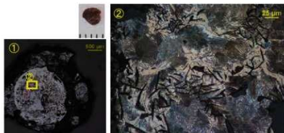
図版3 金属鉄粒・鍛造剥片の顕微鏡組織
