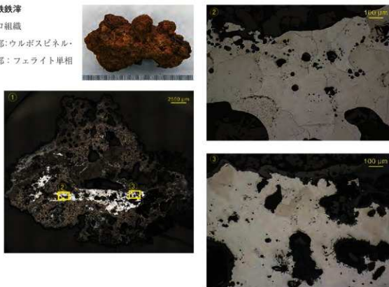
図版3 含鉄鉄滓の顕微鏡組織
