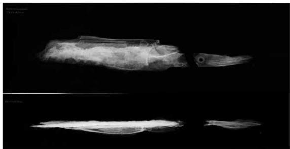
X線透過写真：No 1 平面・断面方向（撮影条件：70-90 kV 5mA 30sec）
