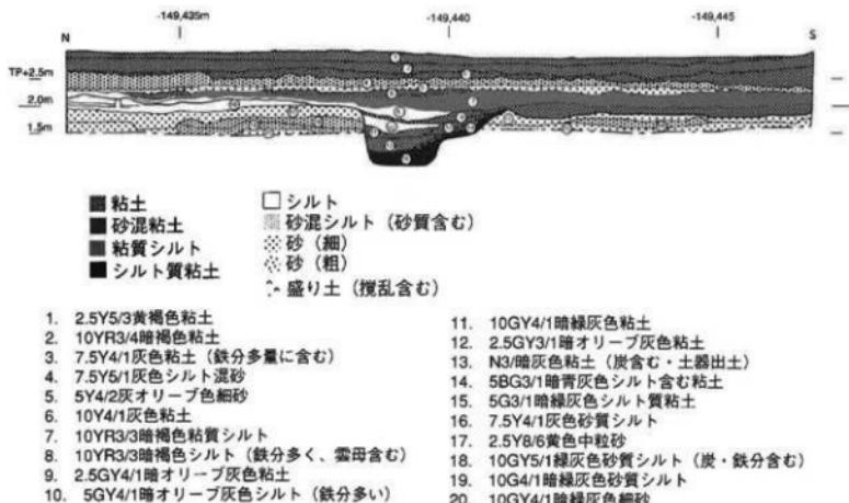
図50 土壤10を含むトレンチ東壁断面図
