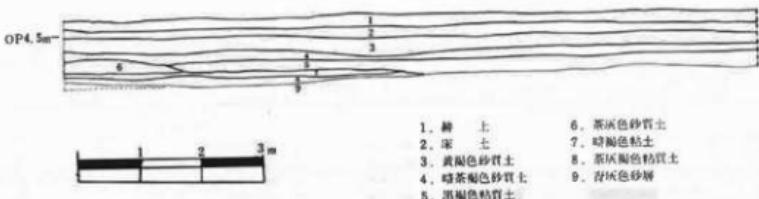
第6図 WET-2トレンチ南壁断面図
