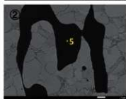
有層鉄弁 (No. 5) の鉄中非金属介在物の特性X線像 (COMP) および特性X線像
