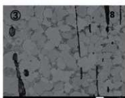
有層鉄弁 (No. 5) の鉄中非金属介在物の特性X線像 (COMP) および特性X線像
