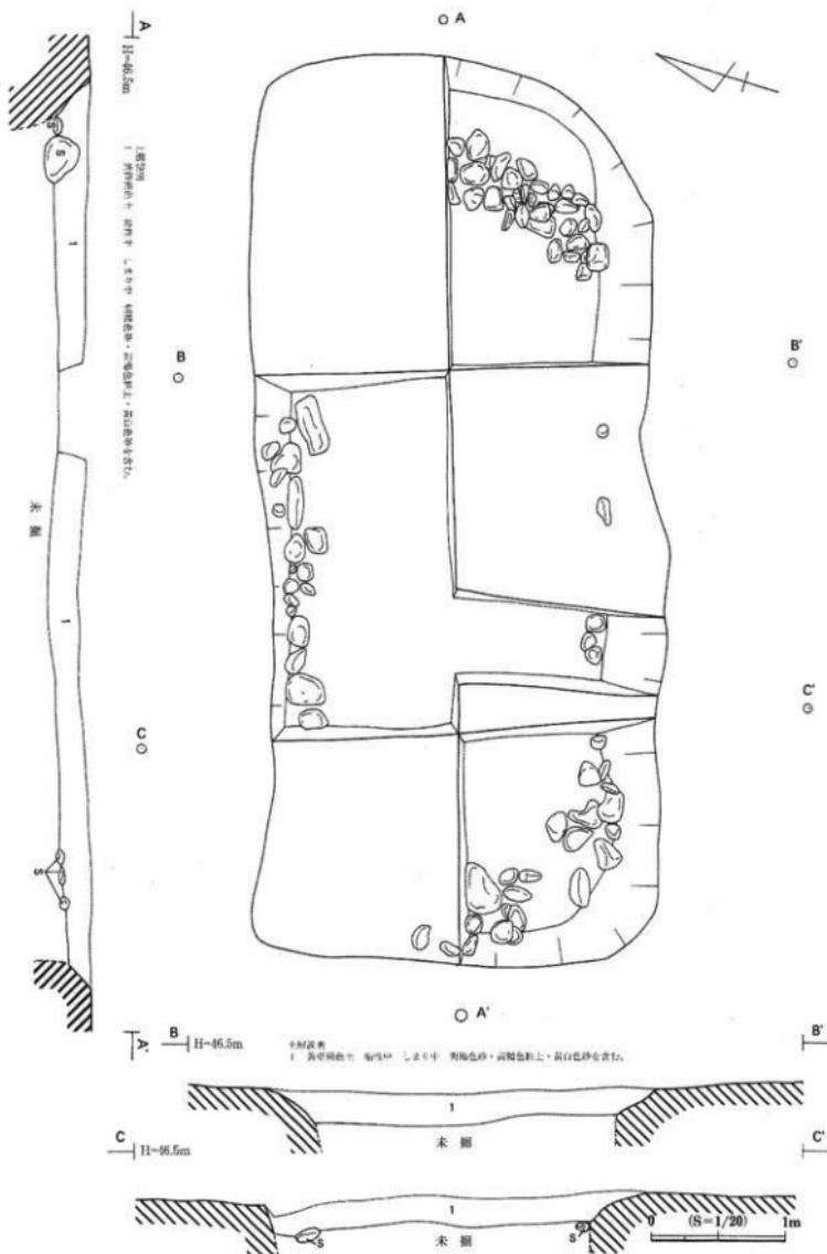
図4 埋葬施設平面図・断面図
