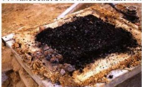
溶解炉とり壊わし後の炉床と炭化物
