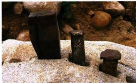
矢入れ実験試行（左から木製・鉄製・鉄製）
