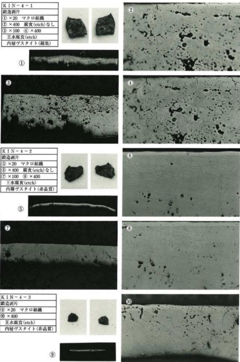
第72図 鍛造剥片 (K I N - 4 - 1・2・3) の顕微鏡組織
