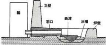
第60図 鍛冶炉断面概念模式図
