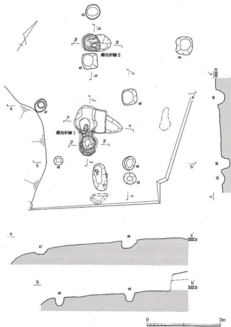
第57図 鑛冶炉跡 1・2 検出状況実測図 (1/40)
