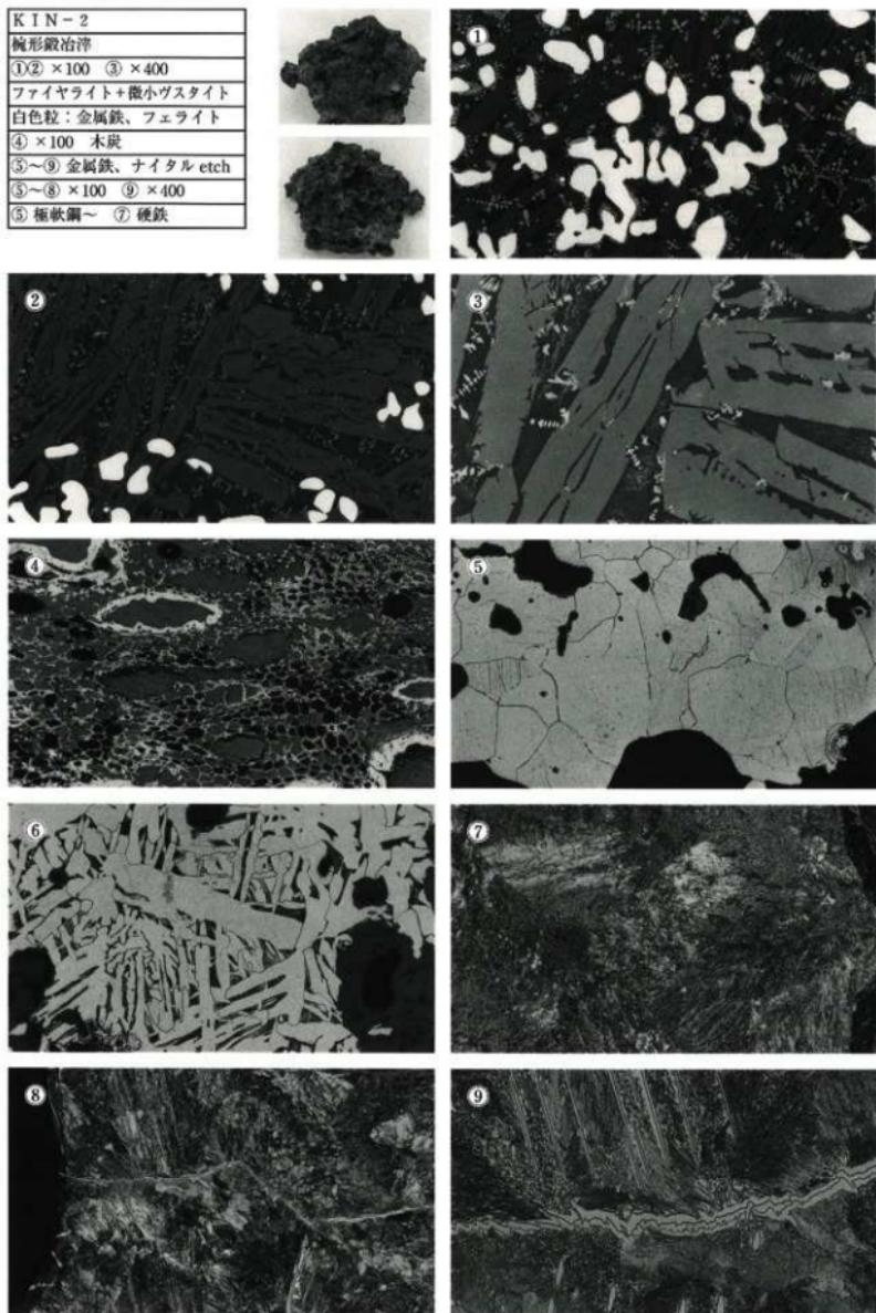
第69図 楕形鍛冶滓（KIN-2）の顕微鏡組織
