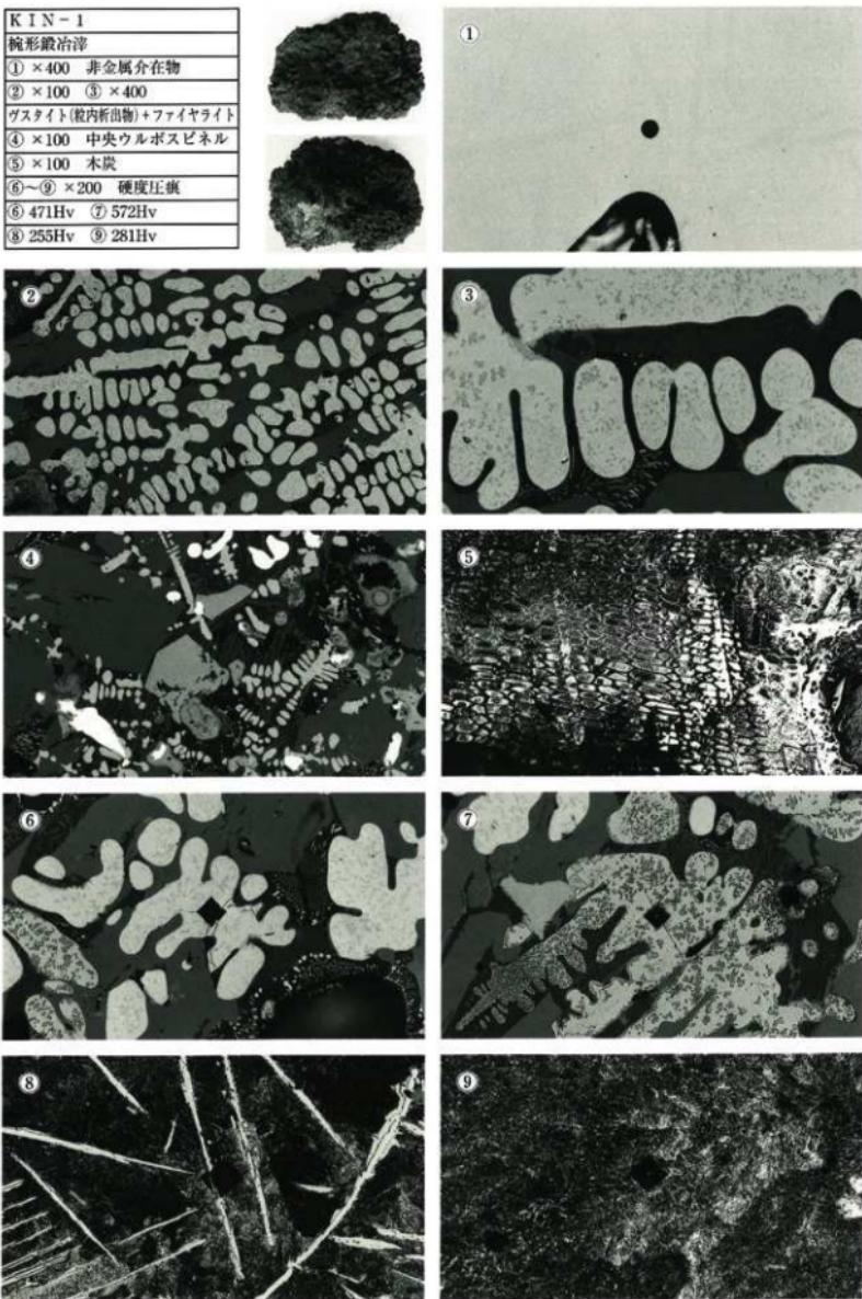
第68図 楕形鍛治溝 (K I N - 1) の顕微鏡組織
