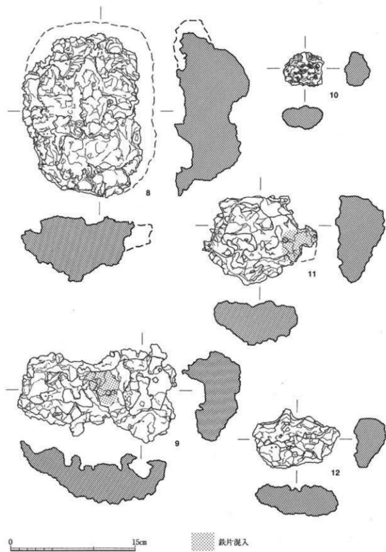
第64図 鉄滓実測図 (1/3)
