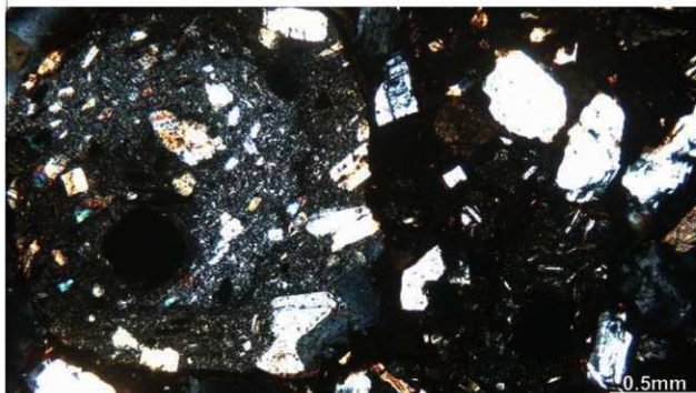
No2 火山岩 (デイサイト) 礫 (Vol), 鉱物粒 上: オープンニコル, 下: クロスニコル Vol: 火山岩 (デイサイト) PI: 斜長石 lo: 鉄鉱
