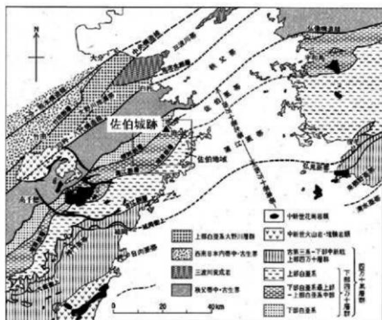
図3 豊後水道周辺の地質構造区分図(寺岡ほか1990に加筆)
