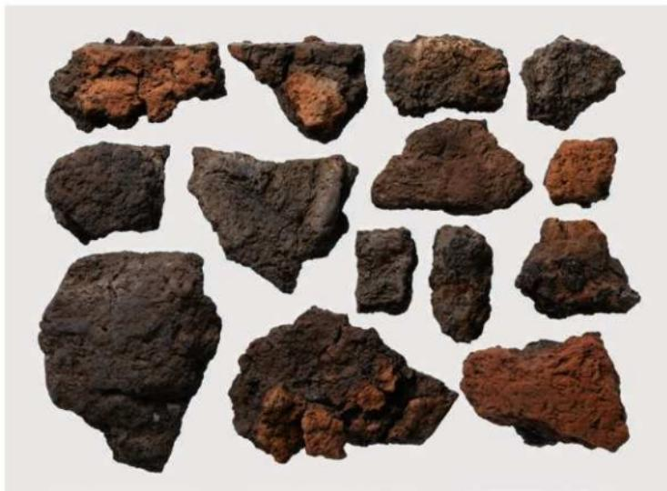
(2) 平らな炉壁と金属滓が付着する炉壁
