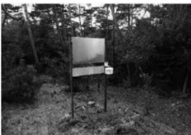
図10 石船塚古墳に設置した温湿度計
