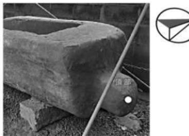
図 19 石船石棺の表面含水率測定箇所（2019 年 6 月）
