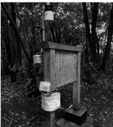
図11 三谷石舟古墳に設置した簡易気象観測装置
