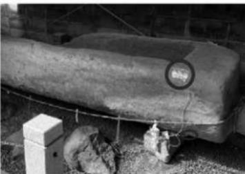
図 16 石船石棺の表面温度測定
