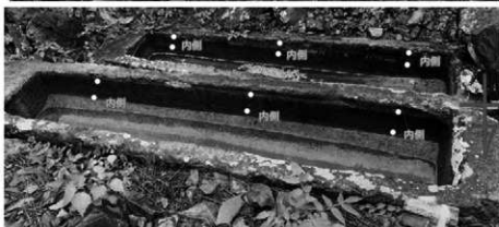
図 20 石船塚古墳石棺の表面含水率測定箇所（2019 年 9 月）
