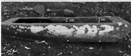
図 21 三谷石舟古墳石棺の表面含水率測定箇所（2019 年 9 月）
