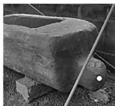
図 19 石船石棺の表面含水率測定箇所（2019 年 6 月）
