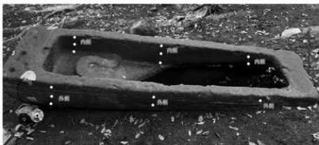
図 20 石船塚古墳石棺の表面含水率測定箇所（2019 年 9 月）
