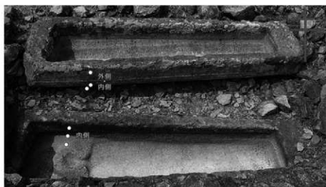
図8 石船塚古墳石棺のエコーチップ試験測定箇所（2019年6月実施）
