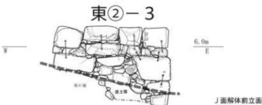
図 10-5 東半石垣石積み技法の分布と改修の履歴②
