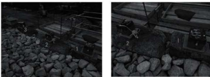
写真6-4 載荷前における常時微動計の設置状況
