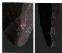
Fig.80 錐部先端の磨耗
