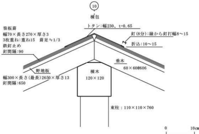
図25 詳細図 屋根葺・棟の納まり (単位mm)
