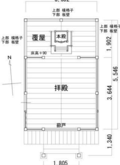
図137-3 平面図(拝殿・上屋)
