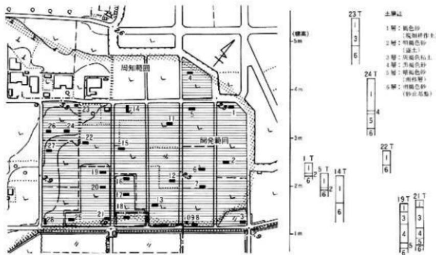
②調査 平成3年11月11日～13日・15日に、開発範囲全域に設定した2m×5m大の試掘坑28カ所をバックホウにより地表下0.4m～約1.5mまで掘り下げて遺跡の遺存状況を調査した。
