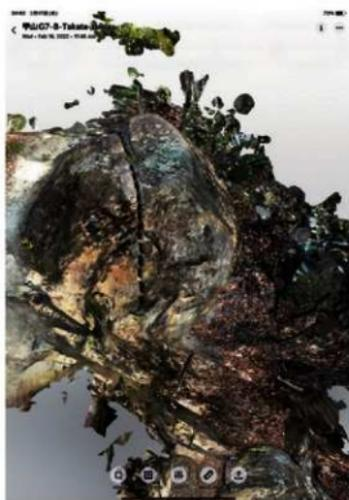
図8 iPadによるLiDAR計測した徳川大坂城石丁場跡東六甲石丁場跡甲山刺印群G7番石材。計測時間は4分
