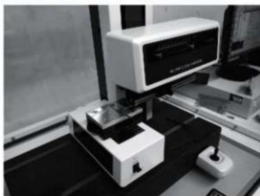
写真3 表面粗さ測定機
