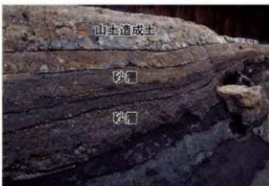
写真3 山土造成土以下に堆積する砂層
