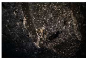
図39 姫島達磨山ガラス質安山岩: 落射光
