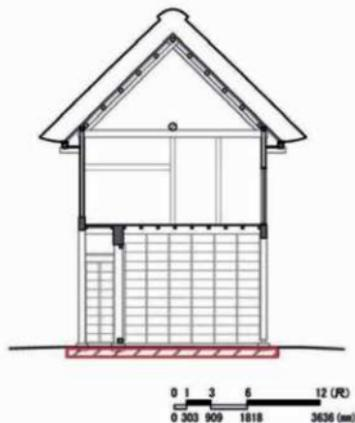
図 2-8 コンクリート基礎のイメージ
