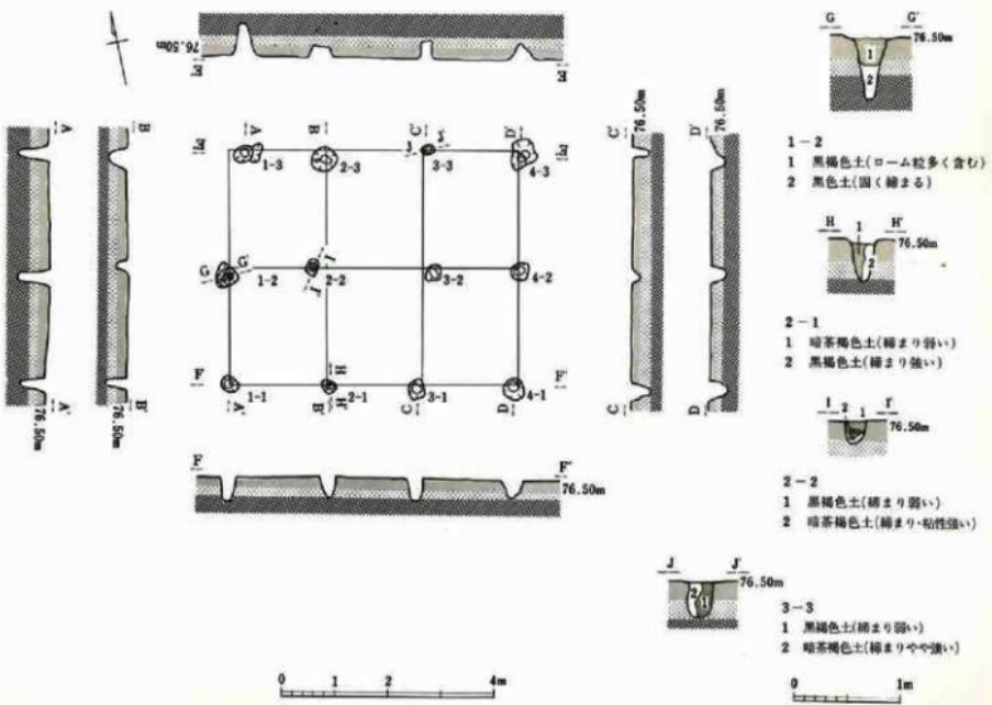
図面58 S B49・50掘立柱建物跡実測図
