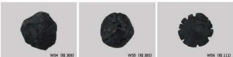
写真2 柱材の端面にみられる切断痕
