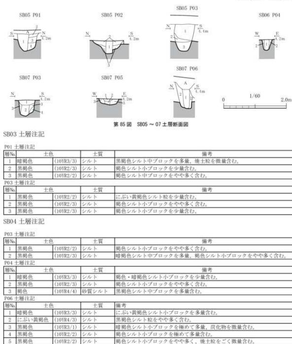
第 85 図 SB05 ~ 07 土層断面図
