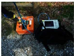
使用機材 (測定器：SIR-3000、アンテナ：400MHz)
