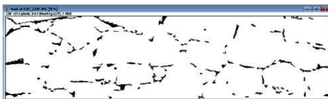
(b) 画像解析により石垣間の隙間部を表示させた画像
