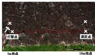
図1 加振伝播速度の概念図
