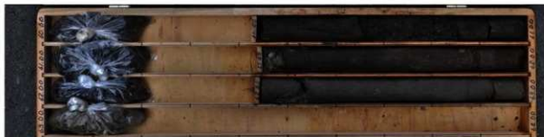
No.1 調査地点 洪積砂質土層・粘性土層
