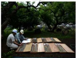
ボーリングコア現地確認
