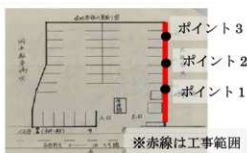
(12) 工事箇所・土層観察ポイント
