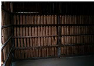
図 4-53 屋根工事 丸瓦乾燥
