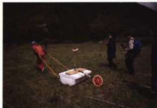
地中レーダー探査風景
