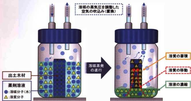
図7 溶媒蒸発を利用した新たな薬剤含浸法の模式図
