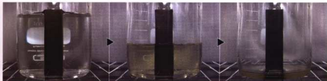
図8 溶媒蒸発を利用した薬剤含浸実験の様子(出土木材試料に顕著な収縮なし)
