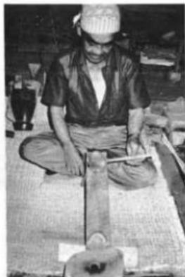
にして固定し、再び中心から手前に向かってエグる。(写真95)そして最後にオタマの周囲が細く均等の厚さで残っているかどうかを確かめて完成する。(写真96)
