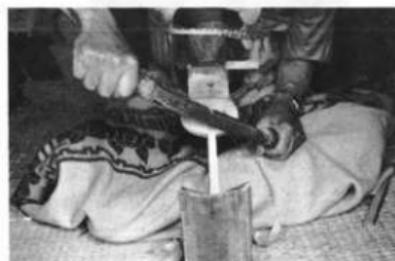
もつと丸い棒状にけずって仕上げる。これをするのが刃のわん曲したエコキセンである。これで少しずつ峯になつてゐる所をけずるとかなり丸くなる。(写真88)この時は普通、表面は柄の先からオタマに向かつてけずり(写真89)、裏側はオタマから柄の先へ向けてけずる。これでシャクシの原型は完成し、最後のエグリで仕上がりとなる。
