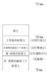
Fig. 14 標準土層堆積図
