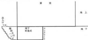
蚕室の地下を貯桑にした近代的蚕室(塩沢)
