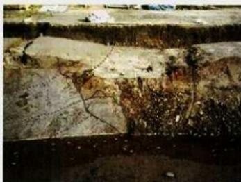
写真1 トレンチ1南端 河床礫の液状化・貫入
