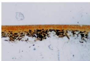
写真6 3外面の塗膜断面写真
