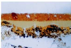
写真2 1外面の塗膜断面写真
