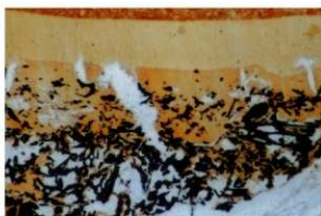
写真4 2外面の塗膜断面写真
