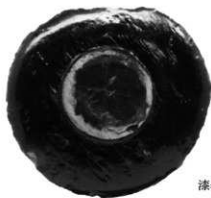
写真1 No. 2-1 内面の塗膜断面 (x400)
