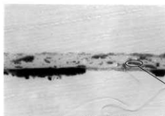
写真2 塗膜の断面写真 (x800)
