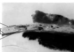
写真3 塗膜の断面写真 (x800)
