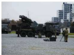
陸上自衛隊高射学校下志津駐屯地の演習風景 03（まるさん）式中距離地对空誘導弾を搭載する車両
