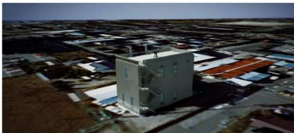
オルソ画像を補整してコンピュータグラフィックスにより3次元の画像を作成 自由に移動、回転できる
