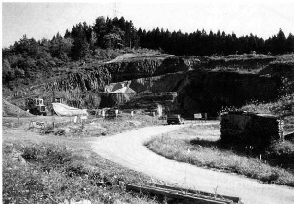
写真2 同上 探掘現場（掘削された崖面に天然アスファルトが滲出する）
