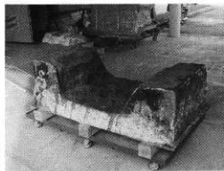
写真49 黒い部分がバーナー使用箇所、失敗
