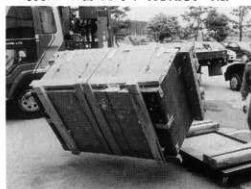
写真34 角材の一部が脱落するも影響なし
