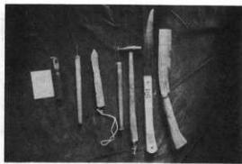
写真100 左からハナカキナタ・キリ・ナイフ・カナヅチ・ノコギリ・ナタ
