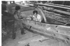
舟の横板の摺り合せ (砂賀造船所)
