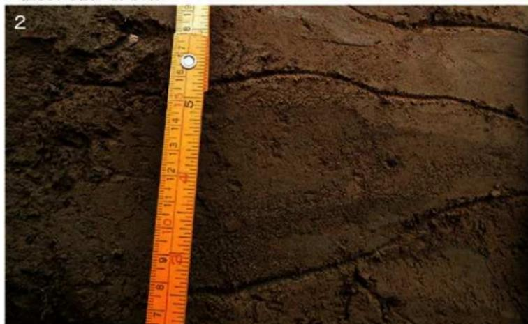
2. 第Ⅱ区のテストピット、トレンチで認められる安平志内川の氾濫時の堆積物であると推定される中粒砂～極細粒砂への級化構造
