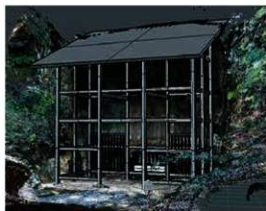
図2 点群データと覆屋CADデータの合成
