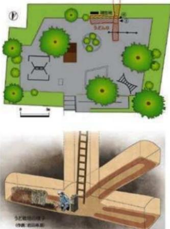
一般的なムロの形状は地表から垂直に下る整坑と、坑底から複数の方向に掘られた横穴で構成されます。この場所では昭和50年頃まで地元の農家がうど栽培をしていましたが、その後公園となり、令和元年に地下ムロが偶然発見されました。発見された地下ムロは安全のため今は埋めていますが、整坑は平面0.8~1.3m四方、深さ4.0mを有し、坑底から北・東・南の3方向に天井高1.2m、奥行き6~4.2mの横穴が掘られ、壁にはムロを掘った時に使用した端の痕が明瞭に残っていました。
