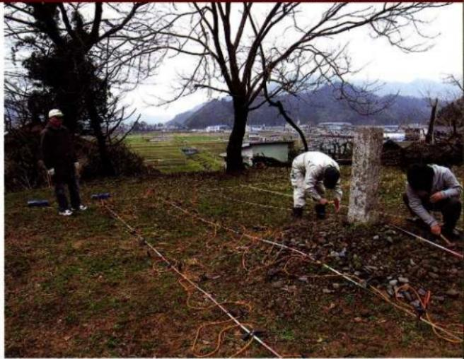
電気探査法による遺跡の探査
